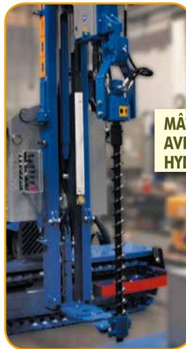
**MÂT DE BATTAGE AVEC TARIÈRE HYDRAULIQUE**
